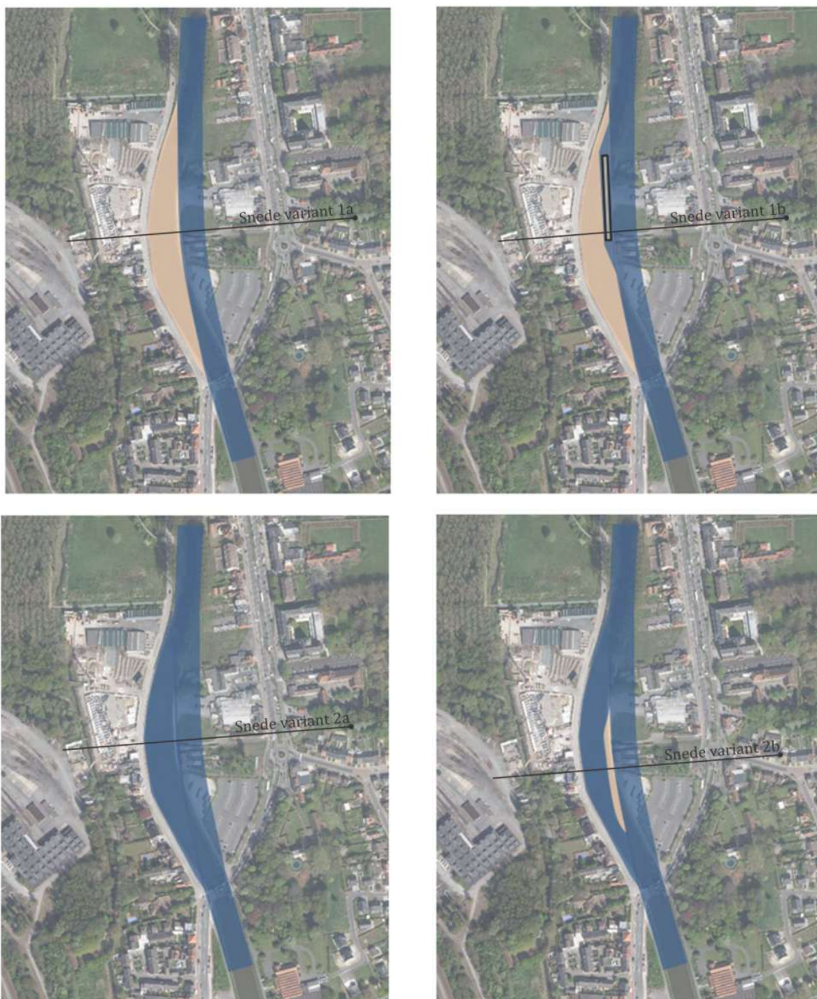
Figuur 7: Redelijke alternatieven voor de bochtaanpassing, conceptuele weergave. De vier redelijke inrichtingsalternatieven vertrekken allemaal van de vaarweg zoals bepaald in de nautische studie. Boven de alternatieven 'Vaarweg aanleggen, rest dempen' – zonder en met passeerstrook, onder de alternatieven 'Vaarweg aanleggen met behoud van bestaande verbreding' – zonder en met behoud van een middeneilandje (of brugpijler) (bron: Project-MER Steenbruggebrug Fase I (december 2016))
